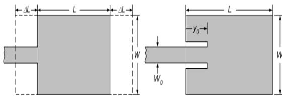
Fig. 2. The microstrip antenna parameters
