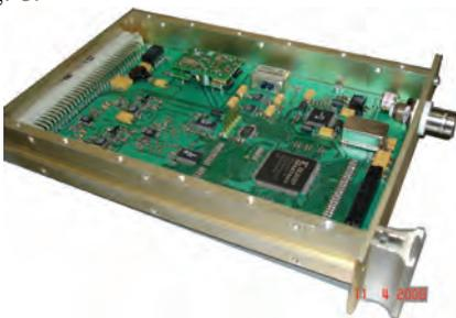
Fig. 6. IMTEL Komunikacije adaptive equalizer unit
